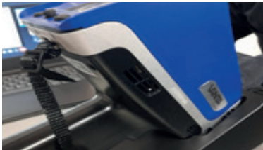
Uso de pistola fluorescencia para la identificación de los precursores cloro y bromo.
